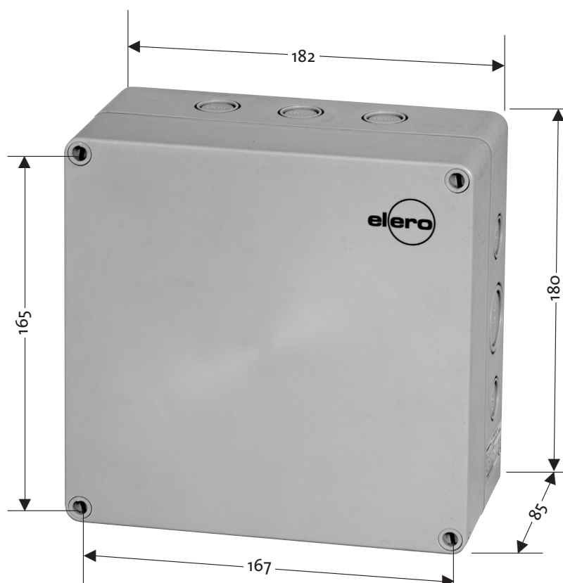
Gehäusebefestigung Unterhalb der Deckelschrauben Bohrungsdurchmesser = 5 mm
