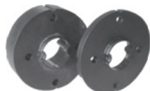
RevoLine Distanzscheiben-Set Umbau von innenliegenden Kurbel auf Rohrantriebe Typ Revoline. Je 1 Distanzscheibe PVC 6,5 + 20,5 mm Achtung: Für die Befestigung Schrau- ben mit Härtegrad 10,9 verwenden! 23.398.9901
